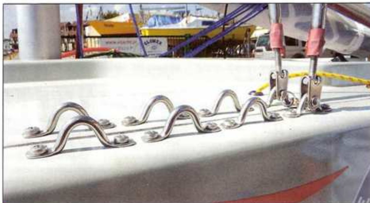
■ Aż cztery pary podwójnych wantowych zainstalowano na obu burtach Protona. Służą one do regulacji położenia want i pochylenia masztu, a przy trzymowaniu takielunku wykorzystuje się je także do kontroli jego ugięcia
