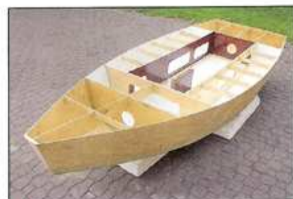
■ Widoczna konstrukcja sztywego kadłuba
